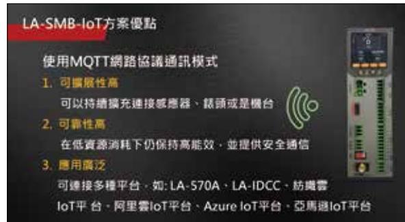
這個設備使用 MQTT 網路協議通訊模式，可以持續擴充連接感應器、錶頭或是機台，可靠性高，在低資源消耗下仍保持高能效，並提供安全通信，而且應用廣泛，可連接多種平台，如 LA-570A、LA-IDCC、紡織雲 IoT 平台、阿里雲 IoT 平台、Azure IoT 平台、亞馬遜 IoT 平台，不只染整廠及織布廠可以用，設備商也可以用。
