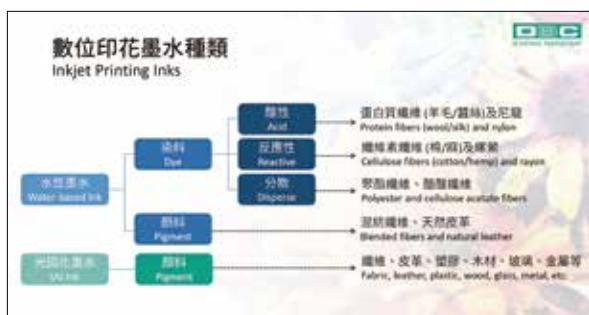
雙鍵針對數位印花墨水致力於開發環保型的全系列水性及光固化墨水，兩種系統皆不含有機溶劑。水性墨水可分為染料及顏料兩種類型，酸性染料應用於蛋白質纖維和尼龍；反應性染料應用在纖維素纖維和繩縷；分散性染料應用在聚酯和醋酸纖維；顏料則可應用於混紡纖維和天然皮革等。而光固化顏料可應用的基材更加多元，包含各種纖維、皮革、塑膠、木材、玻璃和金屬等。
