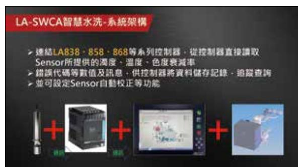
這是系統架構連結 LA838、858、868 等系列控制器，從控制器直接讀取 Sensor 所提供的濁度、溫度、色度衰減率，錯誤代碼等數值及訊息，供控制器將資料儲存記錄和追蹤查詢，並可設定 Sensor 自動校正等功能，可有效降低水洗用水量。
