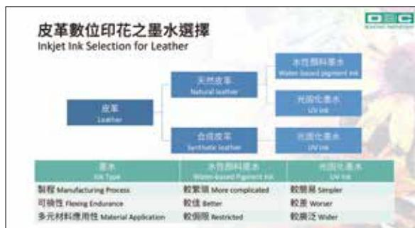
水性顏料墨水數位印花製程僅適用於天然皮革，其有優異的可撓性是光固化墨水較難達到優異物性；而光固化墨水製程相對較簡單，數位噴印後只需經過紫外光照射數秒就能馬上固化，使用者不需投資烘箱乾燥設備，且藉由配方的調整可使光固化墨水對不同基材都能有良好的附著力，因此用途更加廣泛，天然及合成皮革皆適用。
